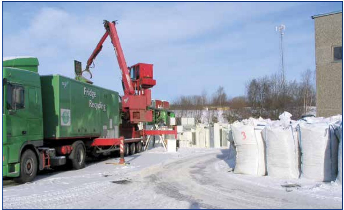
Пункт сбора холодильного оборудования, оснащенный мобильной перерабатывающей установкой
