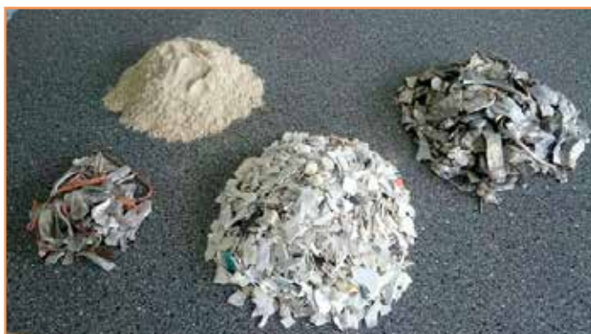
Фото 3. Материалы, получаемые после второго этапа переработки холодильников: алюминий и медь (а); мукообразный пенополиуретан (б); полистирол для дальнейшей переработки в гранулят (в); магнитная сталь (г)
