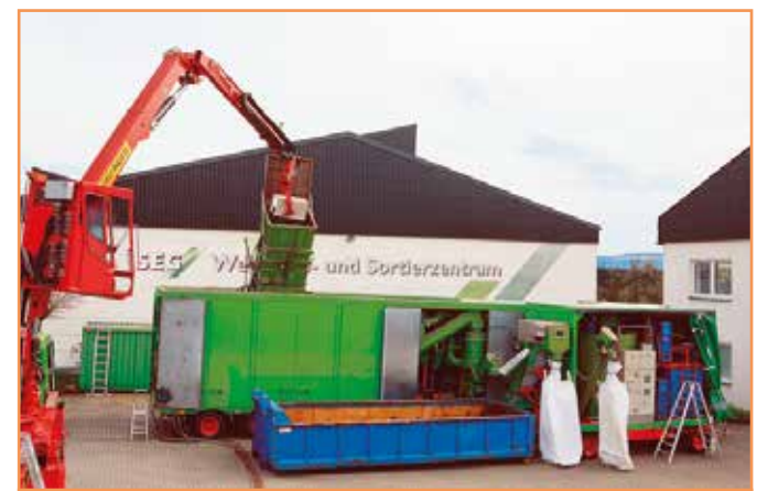
Фото 2. Этап 2 – механическая переработка бывших в употреблении холодильников
