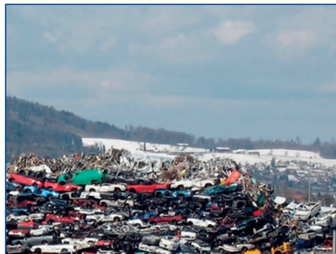
Фото 3. Подержанные автомобили, освобожденные от вредных веществ и предварительно спрессованные. На заднем плане: смешанный лом готов к переработке на шредерном заводе
