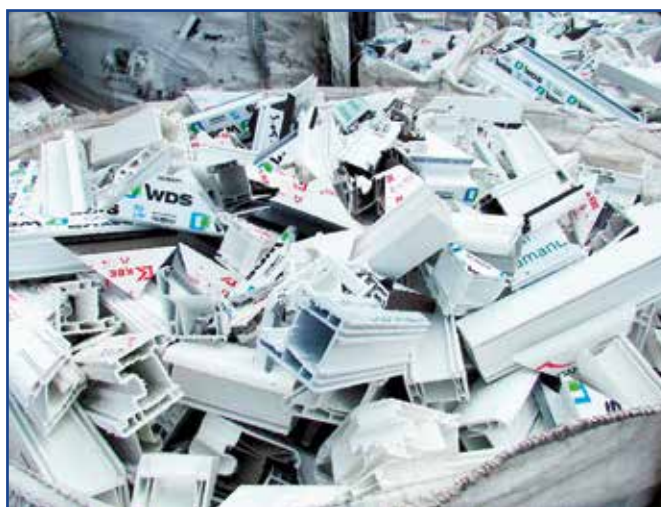
Фото 1. Клиновидные и краевые обрезки-отходы, образующиеся при изготовлении окон из ПВХ-профилей
